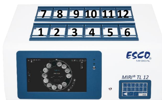
7.2 ábra Kamraszámok a MIRI® TL12 többkamrás IVF-inkubátoron
