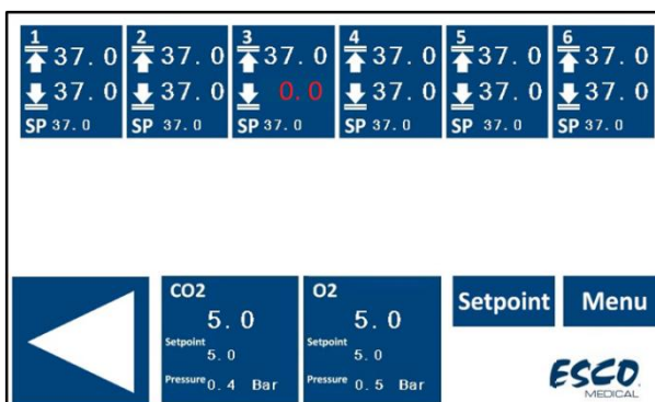
14.4 ábra Hőmérséklet-érzékelő hiba nézete a MIRI® TL6 többkamrás IVF-inkubátor fő kijelzőjén
