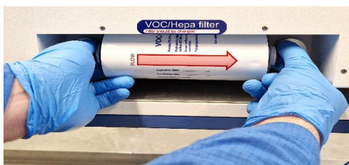
12.2 ábra A VOC/HEPA-szűrő behelyezése és eltávolítása
