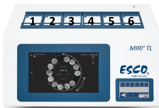
7.1 ábra Kamraszámok a MIRI® TL6 többkamrás IVF-inkubátoron
